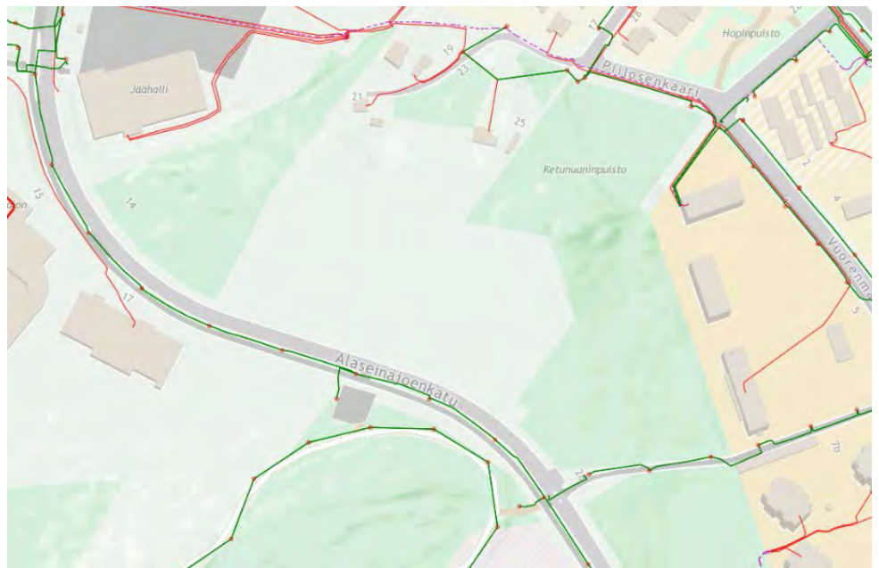
Kuva. Alueen sähköverkot. Vihreä = ulkovaloverkko, punainen = pienjänniteverkko, fuksia = 20 kV verkko.
