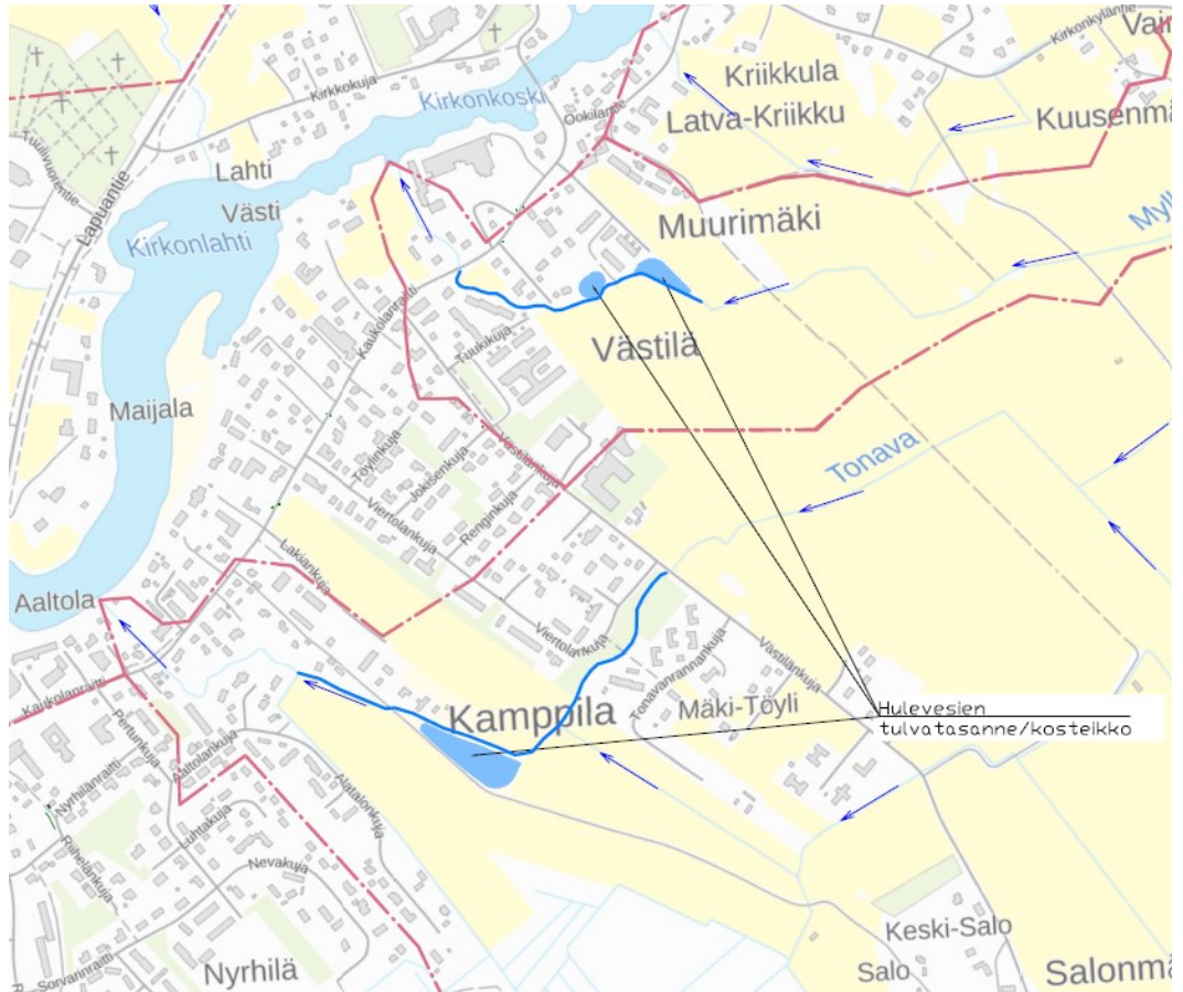
Kuva. Hulevesien hallintaan esitetyt tulvatasanteet/kosteikot
